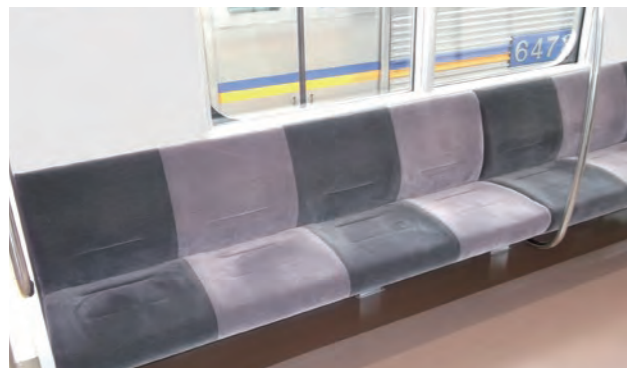
高野線に新造車(8300系)を導入 一人ひとりの座席幅が明確なバケットシートを採用し、定員着席を促進
