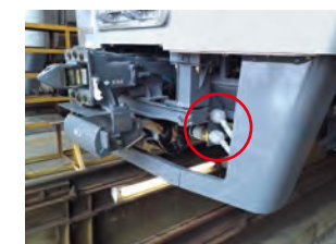
転落防止放送装置
