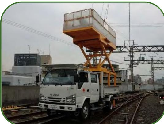
夜間作業で列車や駅設備などに、電気を供給する電線路の点検や補修作業に使用しています。
