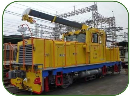
数十トンのレールなどの補修材料を積んだトロリーを工事現場まで運搬(牽引)しています。また台風などの自然災害時に線路の設備点検にも活用しています。
