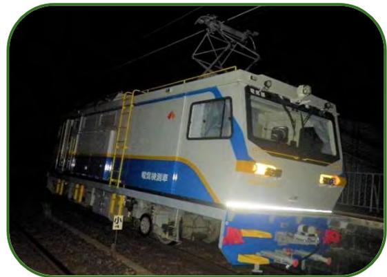
トロリー線の摩耗や架設状況の測定、ATS地上子や列車無線の電波状態を測定するため終列車後の夜間に走行しています。
