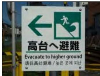
最寄りの出口(踏切道または駅)へ誘導するために、線路の東側に線路と平行して約 80 ~ 100m(電柱 2 本に 1 本程度)を標準として避難方向を表示しています。
