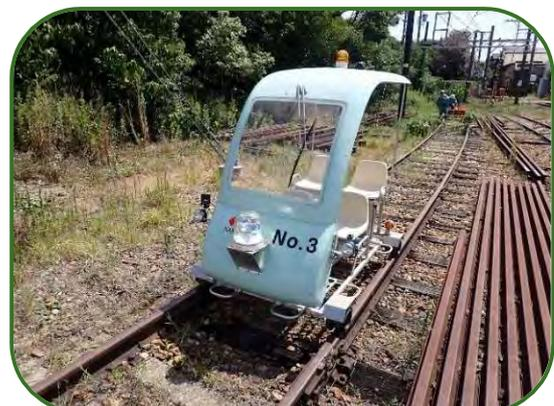
地震発生後や台風通過時の線路設備の点検を迅速に行えるよう、技術事務所に配備しています。
