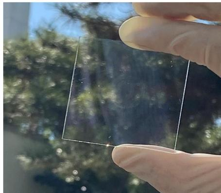
OPTMASSでは未利用の再生可能エネルギーである熱線のエネルギー資源化を可能とする「熱線を電力に変換する透明な太陽電池の開発」を行っています。地表に到達する太陽光の46%は赤外域の太陽光（熱線）であり、この未利用の太陽光エネルギー資源を有効に利用可能な太陽電池は、人類がクリーンで持続可能なエネルギー源である太陽光を今まで以上に有効利用することに貢献します。また、目に見えない熱線を利用して発電することから太陽電池自体を透明化することができ、建物の窓ガラスで発電するなどの未来のエネルギー生産プロセスを提案することが可能になります。OPTMASSでは2030年度の社会実装を目指し、透明太陽電池の開発に取り組んでいます。
